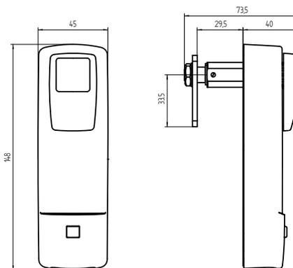
La serrure d'armoire électronique MO convient pour une utilisation sur les casiers, les armoires, les portes en acier, en bois ou en aluminium jusqu'à une épaisseur de porte de 20 mm maximum. La solution de fermeture alimentée par pile est disponible avec différents verrous et peut être utilisée en mode hors ligne ou en mode sans fil en ligne. Le remplacement des piles nécessite un outil de remplacement des piles.
